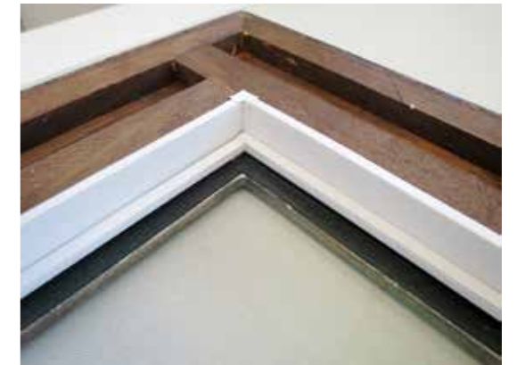
Veranschaulichung Aufbau ausgeklebter Falz, mit Archiv-Rahmenversiegelungsband, Plastazote und ummantelter Holzdistanz (Foto: Ines Aßmann)
