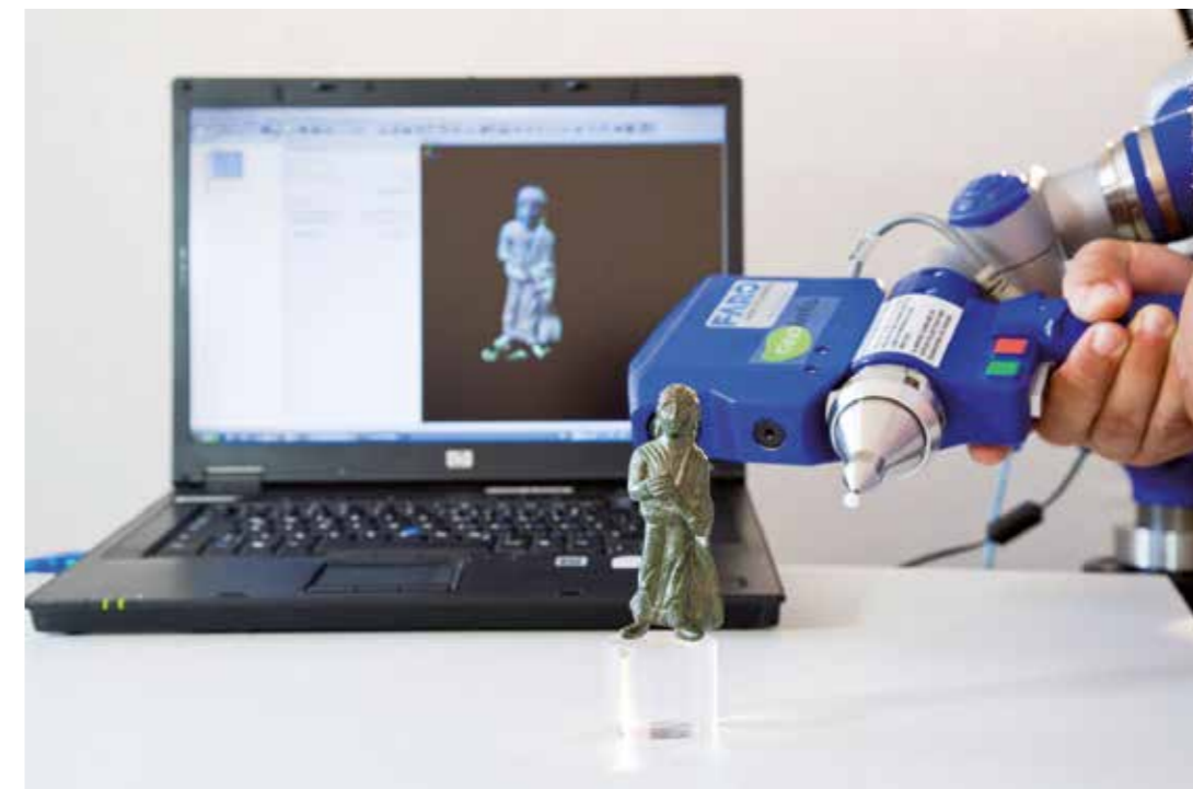
Scannen einer Bronzestatuette mittels FARO-Laserscanner, Abt. Hydrologie und Geoinformation (Foto: B. Stummer)
